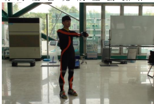
圖 2.利用動作捕捉器擷取發球動作
